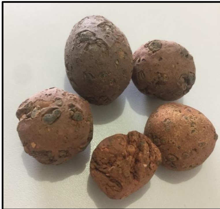
Figura 1 - Argila Expandida produzida em altas temperaturas
