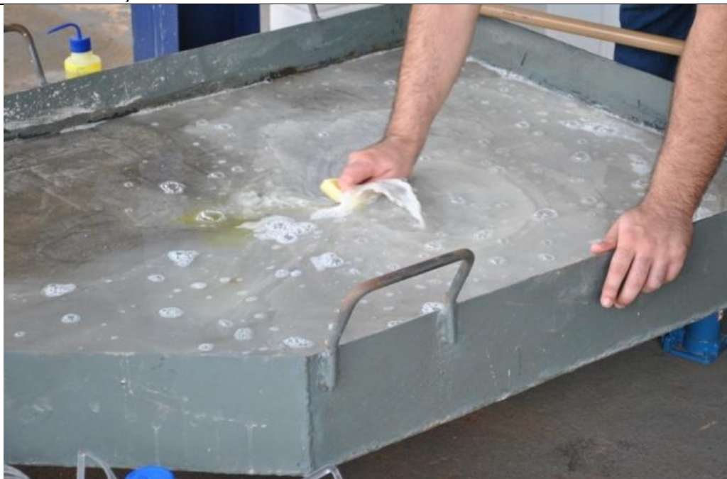
Figura 18 – Remoção manual do óleo utilizando bucha e surfactante.
