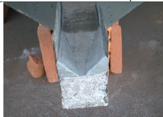
Figura 7 – Apoio do aparato com tijolos e redução da secção da vazão do exutório manufaturada com massa adesiva epóxi.
