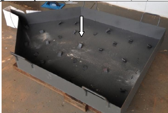
Figura 5 – Bandeja metálica contendo ganchos para fixação do concreto (seta).
