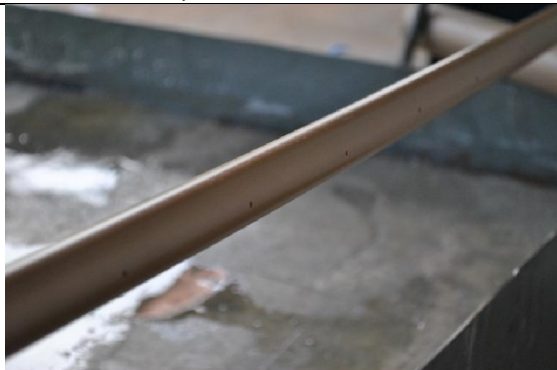
Figura 10 – Tubulação de diâmetro 25 mm com furos de 2,5 mm. Figura 11 – Detalhes da caixa de água, válvula e tubulação de 25 mm.
