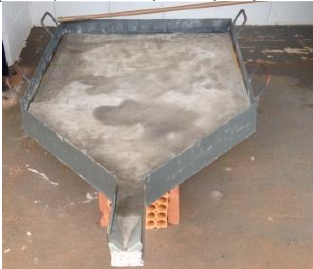
Figura 9 – Configuração final do modelo experimental da superfície impermeabilizada.
