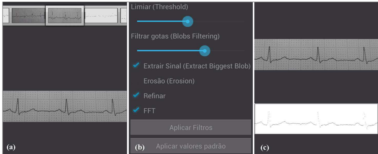
Figura 19 - telas para filtrar as imagens. Em (a) deve se escolher o ECG, (b) ajustes dos algoritmos de filtragem e aplicação, e em (c) o resultado comparando com a imagem original.
