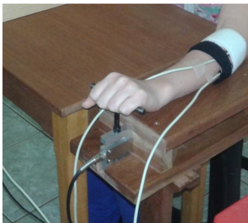
Figura 2: Célula de carga para contração isométrica voluntária máxima. Fonte: Da autora, 2014.
