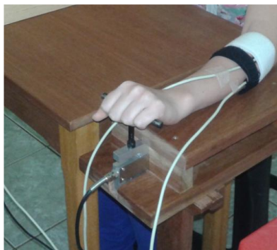
Figura 2: Célula de carga utilizada para Contração Isométrica Voluntária Máxima. Fonte: da Autora, 2014.
