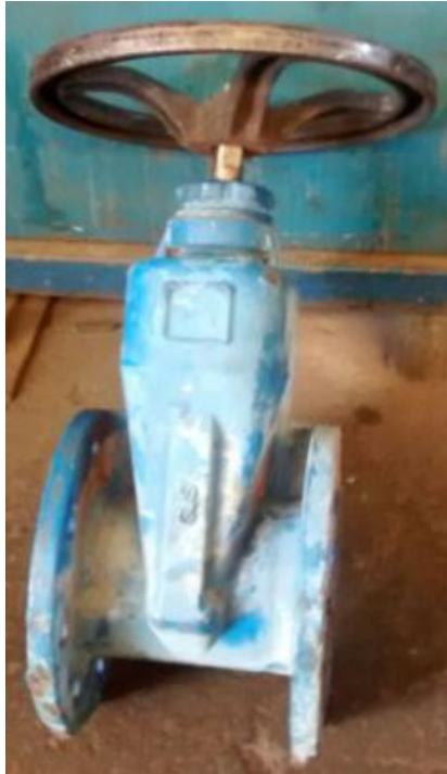
Figura 1 - Válvula de Gaveta de 100 mm com volante.
