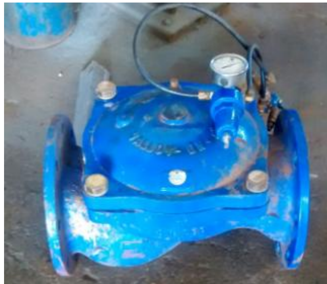
Figura 7 – Válvula redutora de pressão.
