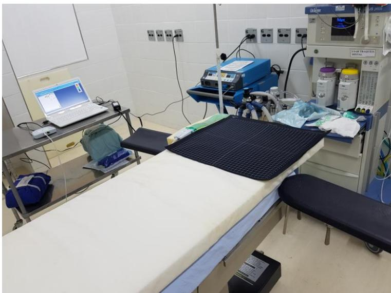
Figura 38: *Software* CONFORmat<sup>®</sup> conectado à malha de sensores. Uberaba (MG), 2017.
