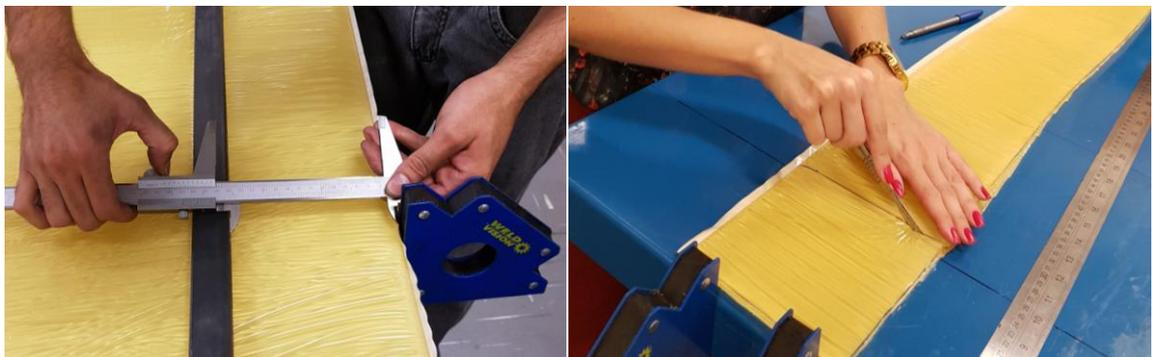
Figura 21: Preparo dos corpos de prova do polímero viscoelástico para a realização do teste B, LPM. Uberlândia (MG), 2017.
