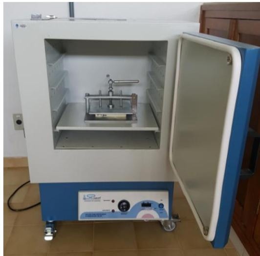
Figura 28: Dispositivo de compressão e corpo de prova no interior da estufa. Uberaba (MG), 2017.
