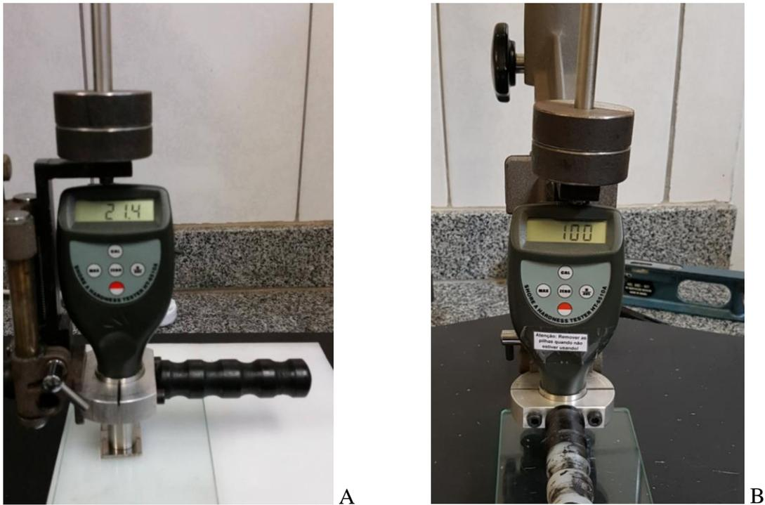
Figura 22: Calibração do durômetro, modelo HT 6510-A, marca Medtec<sup>®</sup>, LPM. Uberlândia (MG), 2017.
