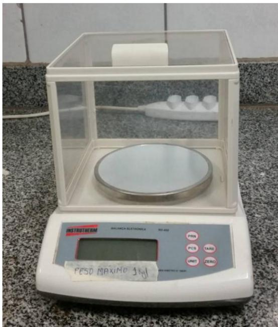
Figura 17: Balança de precisão, marca Instrutherm<sup>®</sup>, modelo BD450, LPM, UFU. Uberlândia (MG), 2017.
