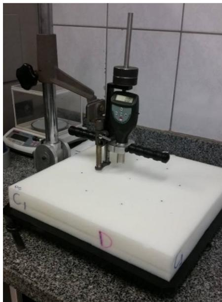
Figura 23: Avaliação da dureza em nove pontos de medida, LPM. Uberlândia (MG), 2017.
