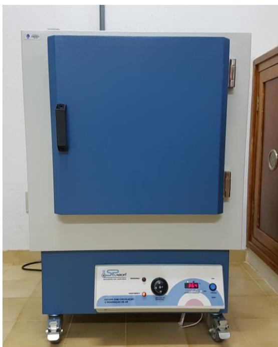
Figura 15: Estufa de secagem com circulação e renovação de ar, marca SPLABOR®. Uberaba (MG), 2017.
