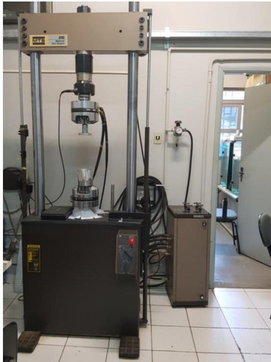
Figura 13: Máquina Universal de Ensaio 810 - componentes 1, LPM, UFU. Uberlândia (MG), 2017.
