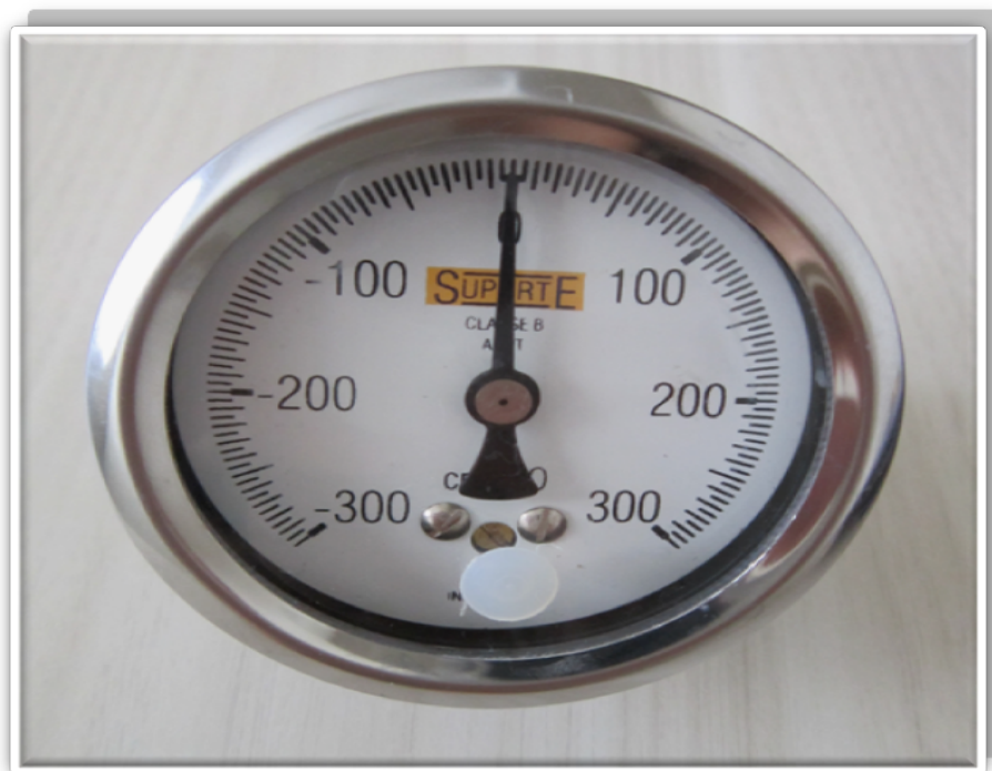
Foto C: Manovacômetro (graduado de -300 + 300 cmH 2 O)
