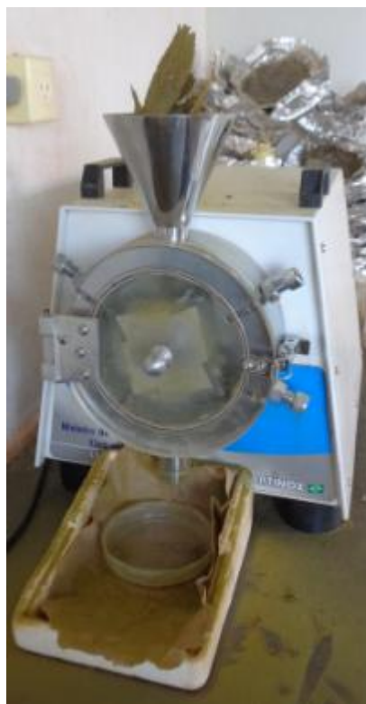
Figura 17 – Moinho de facas: utilizado na trituração das folhas, pétalas, cálices e sementes.
