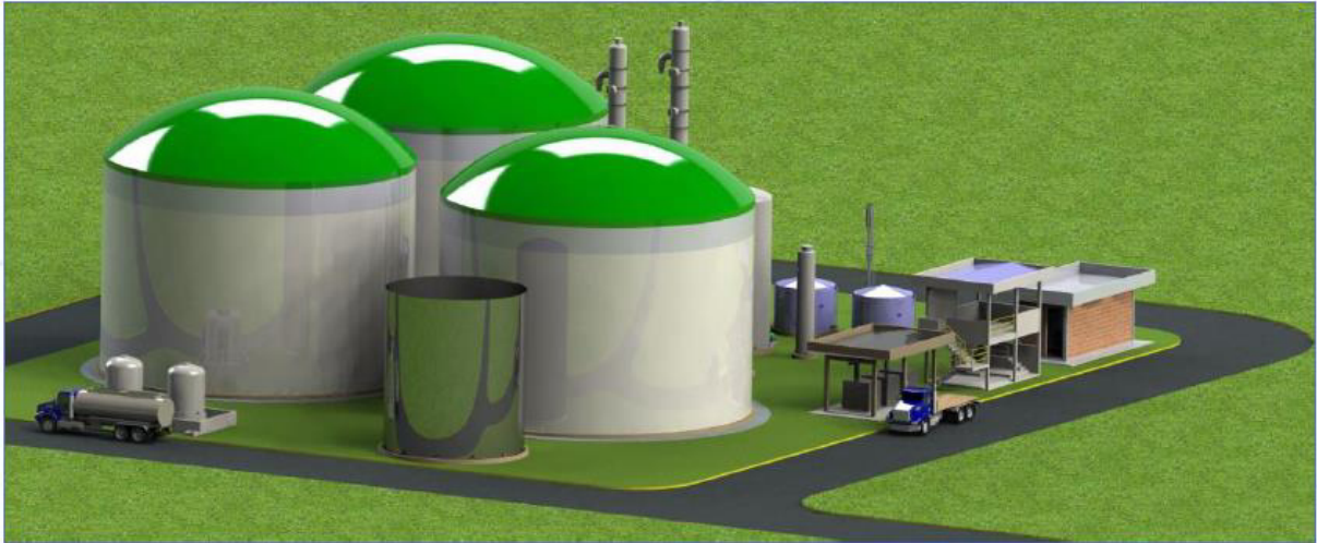
Figura 16 – Imagem ilustrativa do sistema de biodigestão anaeróbia para vinhaça.
