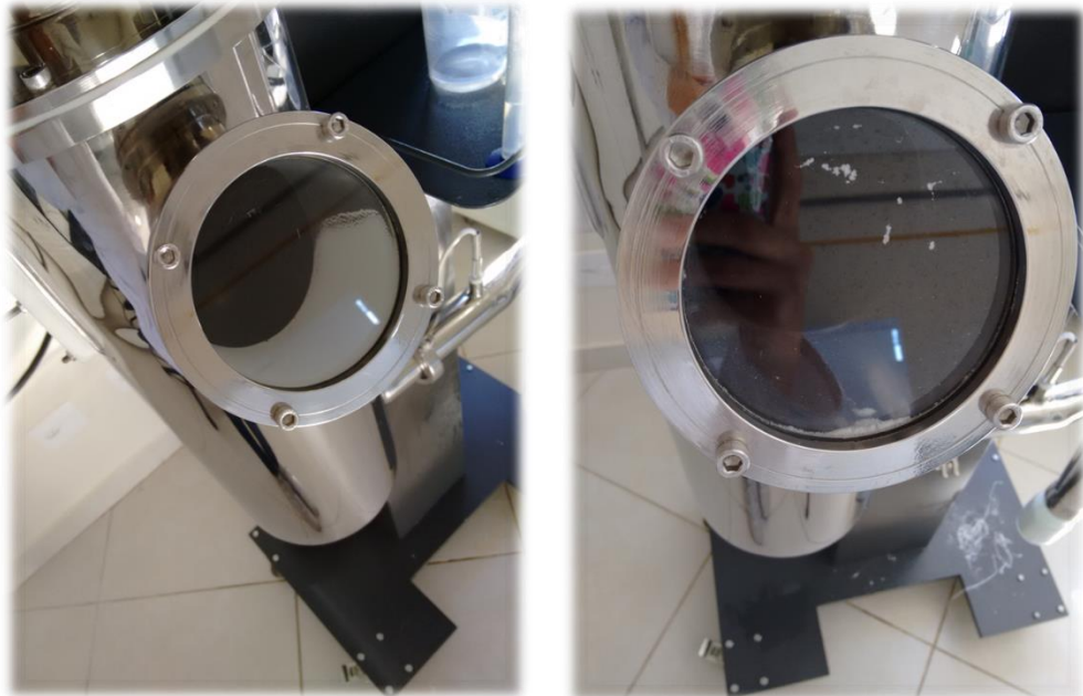
Figura 24 - Adesão das partículas à parede (baixo e alto rendimento, respectivamente)
