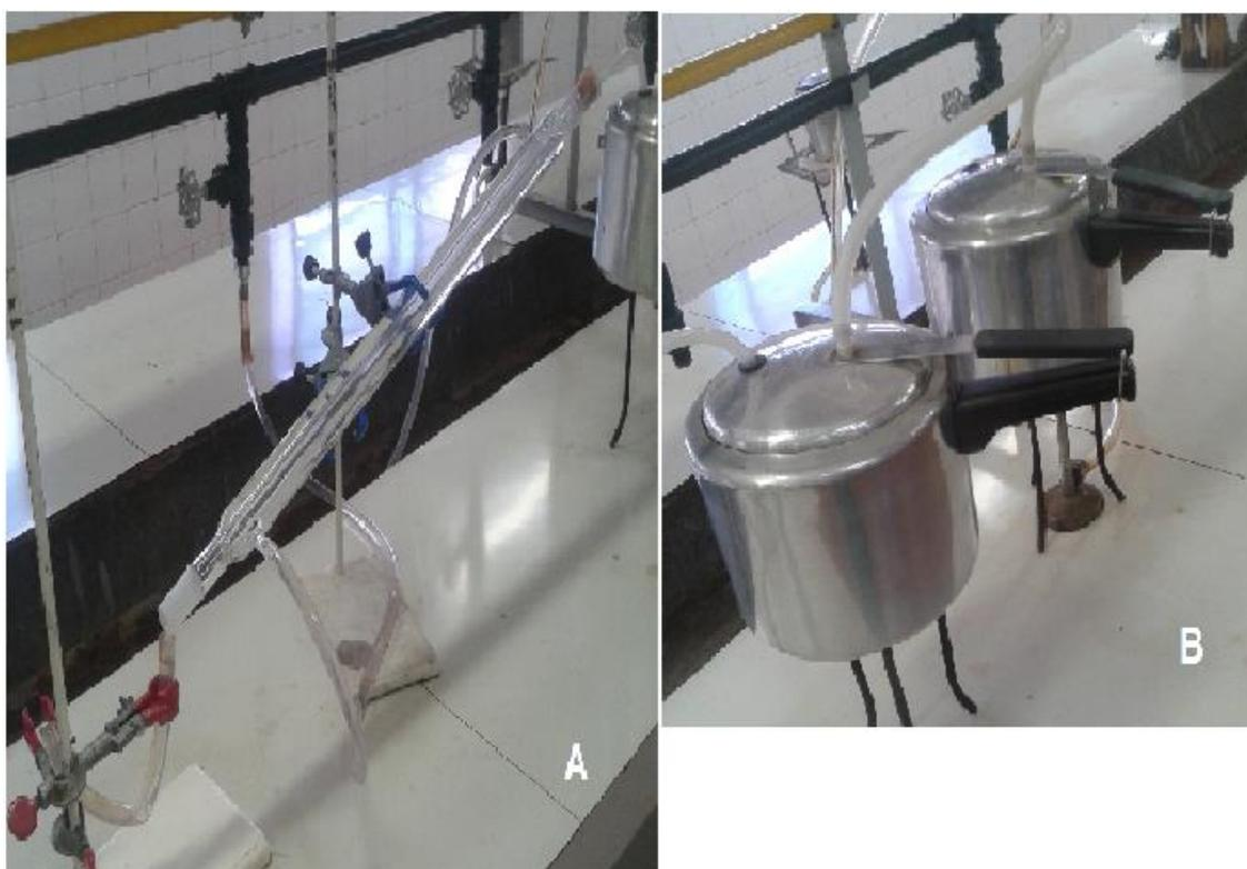
A) Condensador e recipiente de separação e coleta. B) Recipiente para aquecimento água e recipiente para material vegetal.
