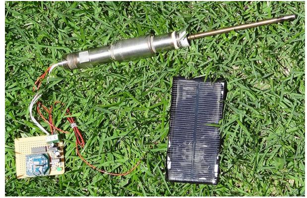
Figura 20 - Circuito dispositivo final sendo alimentado por energia solar.
