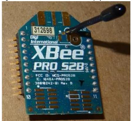
Figura 16 - Módulo XBee Pro Série 2 utilizado do projeto.
