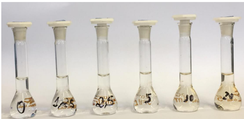
Figura 24 – Amostras das 5 diluições do ácido húmico para criação da curva de calibração
