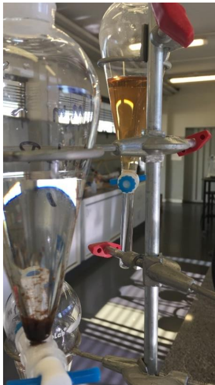
Figura 34 – Amostras com 1ml de peróxido após 24 horas de repouso. À direita amostra com sem tratamento. À esquerda amostra com 3 minutos de tratamento.
