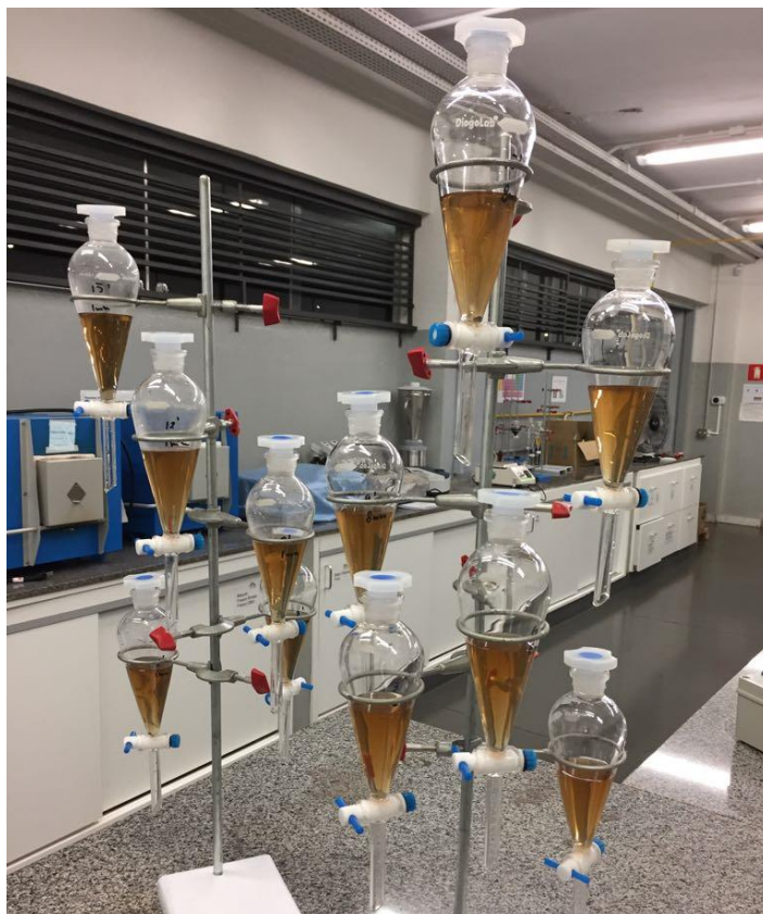
Figura 22 – Amostra em repouso nos balões de separação
