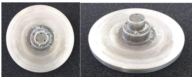
Figura 21 – Placa de 3 espessuras com 9 furos em alumínio
