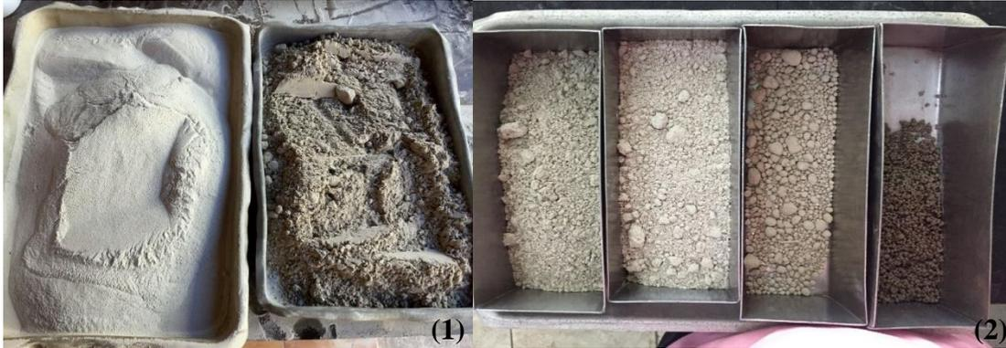
Figura 9 – (1) Resíduo 1 a esquerda e resíduo 2 a direita. (2) Da esquerda para direita, o último é o material adequado onde foi encontrado o ponto para iniciar os testes de granulação, após ajustar todo o conjunto do granulador, rotação, ângulo de granulador e bico spray de adição de líquidos
