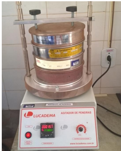
Figura 14. Agitador de peneiras utilizado para seleção granulométrica.
