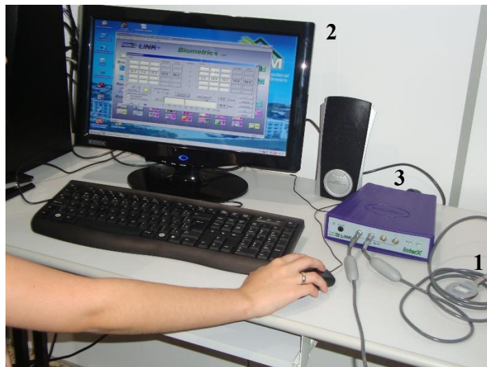
Figura 1: Componentes do Kit E-Link da Biometrics. (1: dinamômetro de pinça; 2: computador com alto-falante; 3: interface InterX)
