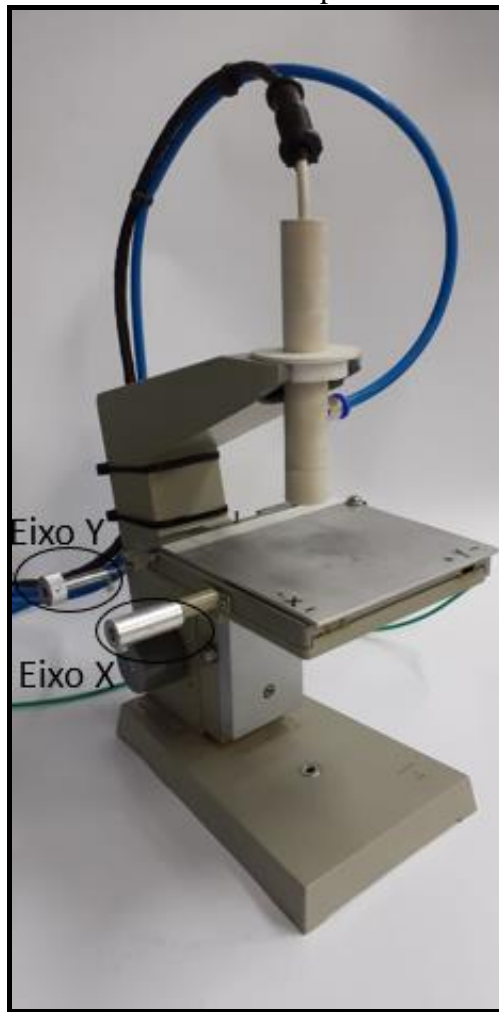
Figura 11 – Imagem representativa dos eixos X e Y do sistema de injeção de plasma e o porta-amostras do equipamento de plasma atmosférico para demonstração do posicionamento dos motores de passo.
