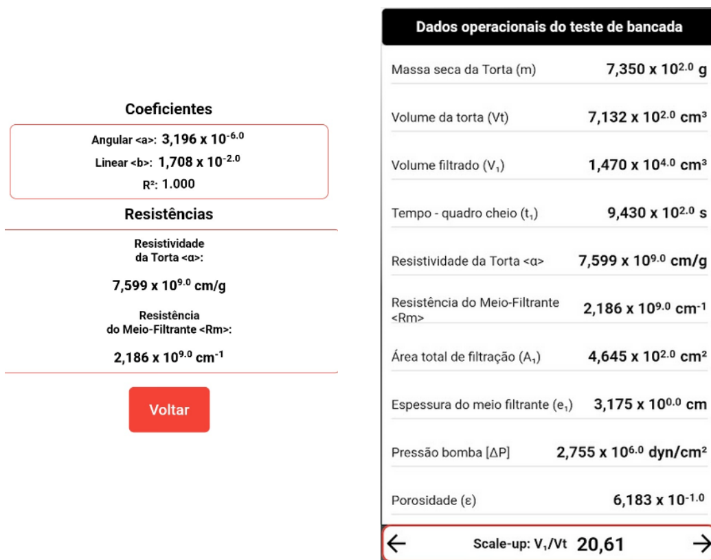
Figura 97: Coeficientes e resistências calculadas após regressão (a) e relatório do teste em filtro de bancada (b)
