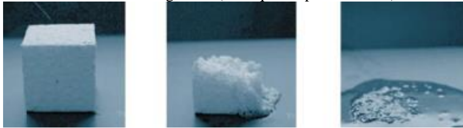
Figura 4: Dissolução de EPS com d-limoneno, nos intervalos de 0, 30 e 180 segundos (da esquerda para a direita)
