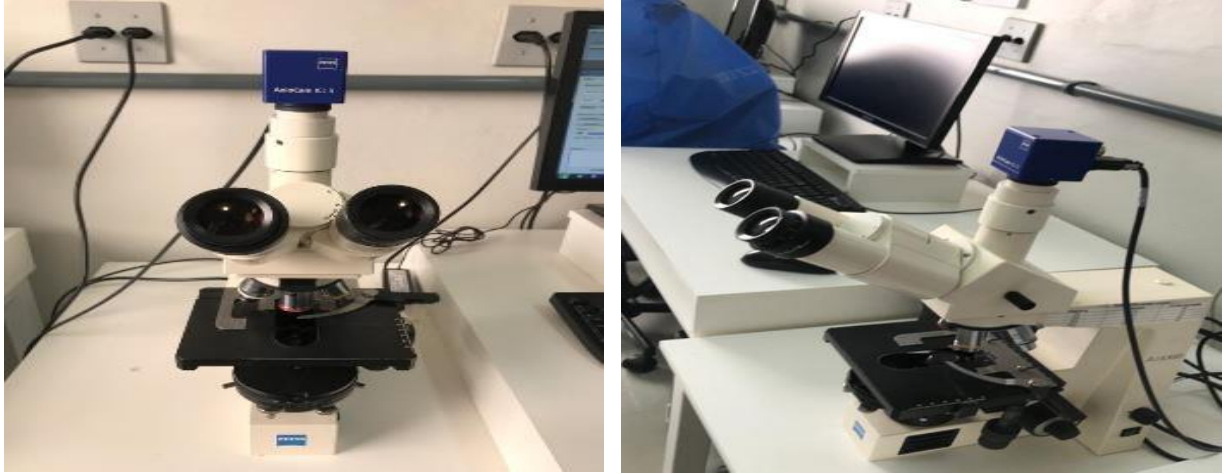
Figura-3. Microscópio zeiss Axion com câmera acoplada ICc 5, utilizado para realização das análises das espessuras das trabéculas ósseas e do colágeno. Fonte: arquivo próprio.
