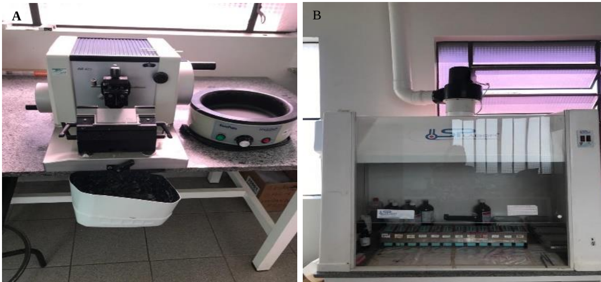
Figura-1. Laboratório de histotécnicas da disciplina de Patologia Geral da UFTM utilizado para confecção das lâminas. A) micrótomo da marca Microm modelo OUT400 utilizado para os cortes histológicos, B) Capela da marca SP Labor utilizada para realização das colorações com Hematoxilina eosina (HE) e Picrosírius (PS). Fonte: arquivo próprio.
