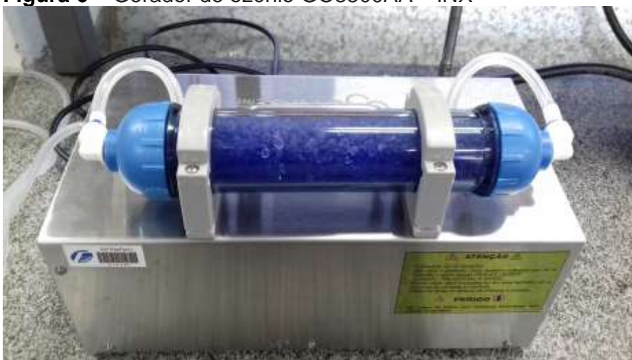
Figura 6 – Gerador de ozônio GO3500AA – INX
