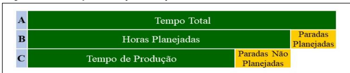
Figura 5 - Classificação dos tempos da máquina de envase de leite UHT
