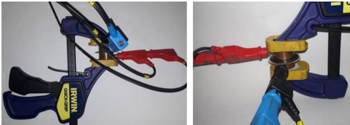
Figura 11 - Aparato para medição de supercapacitores ASSSCs.
