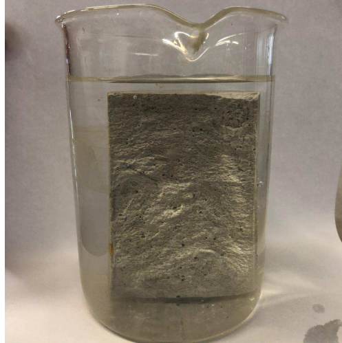
Figura 19 – Ensaio de perda de massa por submersão em água
