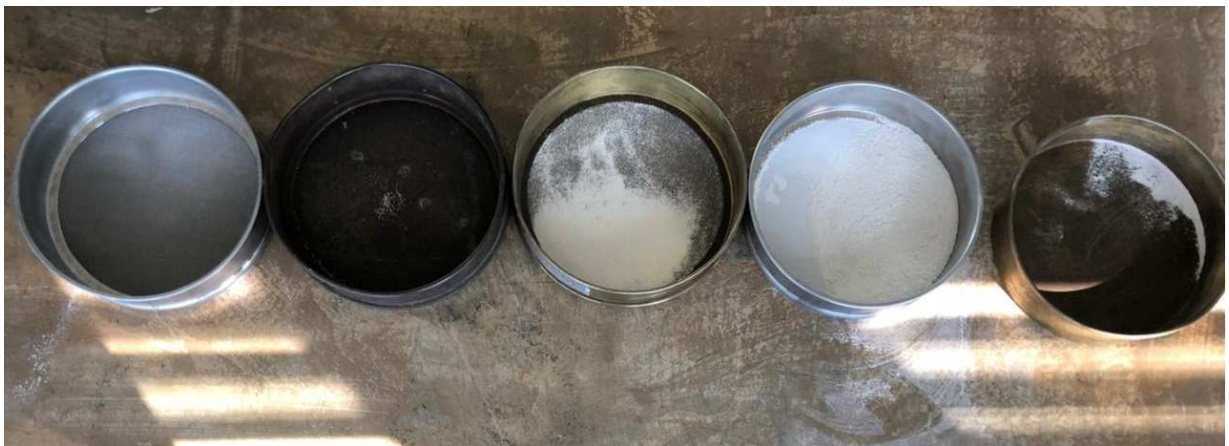
Figura 11 – Massa retida em peneiras 0,840, 0,420, 0,210, 0,105 mm e fundo (da esquerda para direita, respectivamente), utilizadas para ensaio granulométrico e módulo de finura
