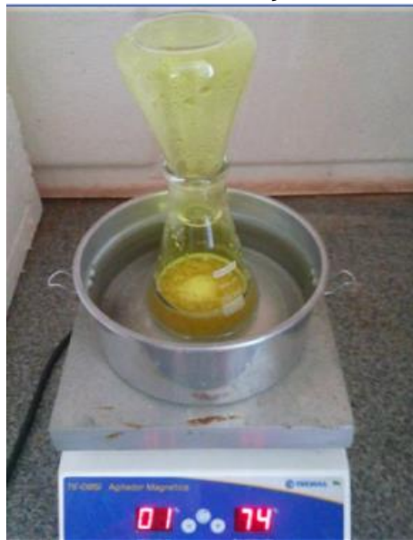
Figura 10 – Sistema de extração de holocelulose.
