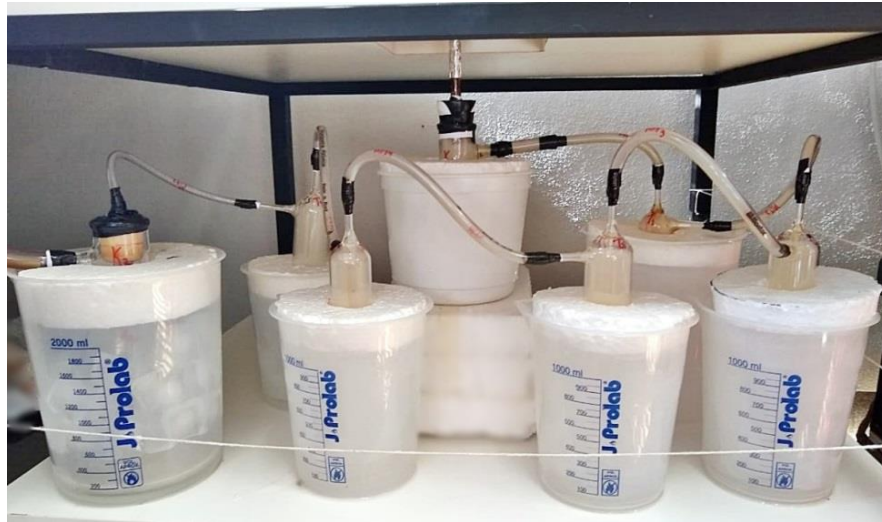
Figura 13 – Sistema de condensação
