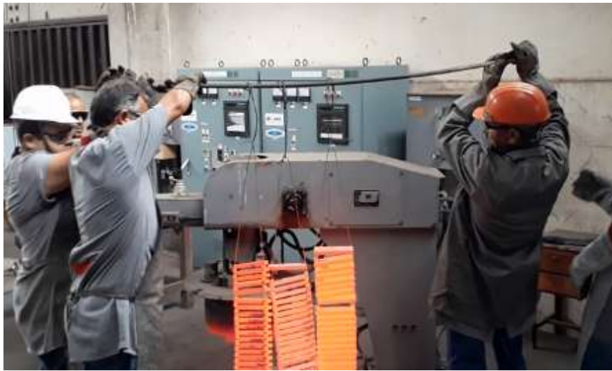
Figura 38 - Transferência dos corpos de prova para o banho de austêmpera
