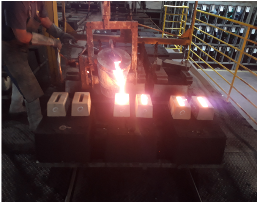
Figura 35 - Vazamento dos corpos de prova
