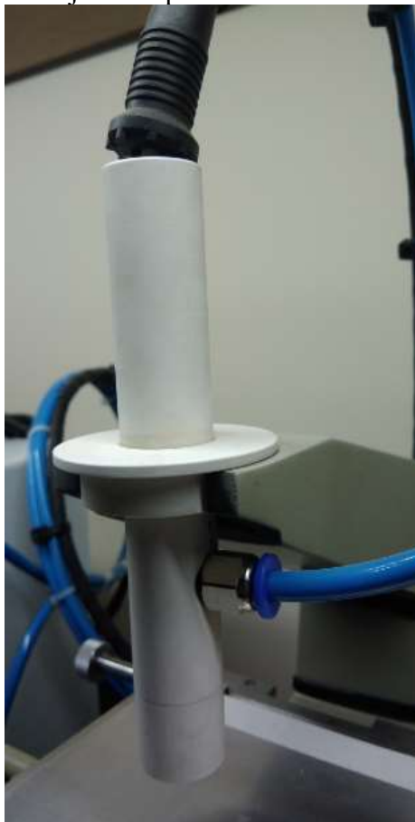
Figura 34 - Bico injetor de plasma modificado – Versão final
