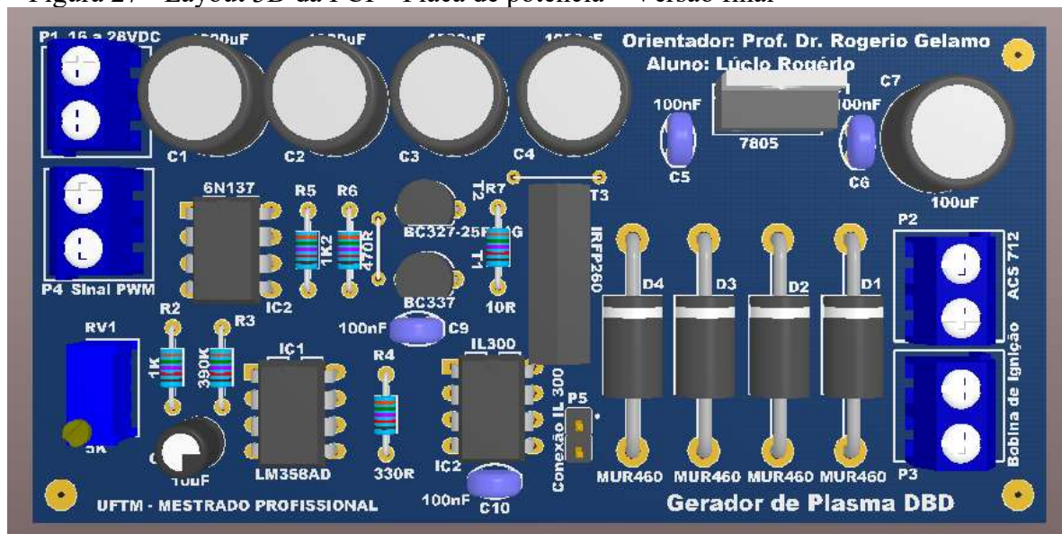
Figura 27 - Layout 3D da PCI – Placa de potência – Versão final
