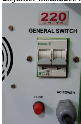
Figura 9 - Fusível e disjuntor instalados no gerador de plasma
