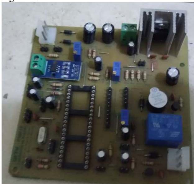
Figura 28 - Placa de controle – Versão Final
