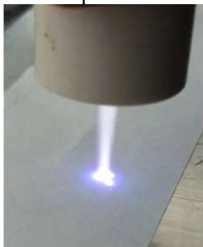
Figura 40 - Jato de Plasma à pressão atmosférica com gás hélio
