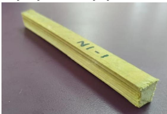
Figura 12 - Corpo de prova analisado por perda de resistência mecânica
