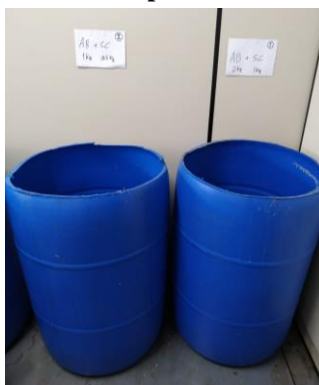
Figura 8 – Barris de tratamento por imersão dos entrenós de bambu
