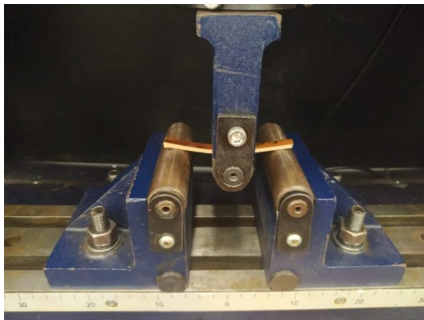
Figura 18 – Corpo de prova em ensaio de flexão estática
