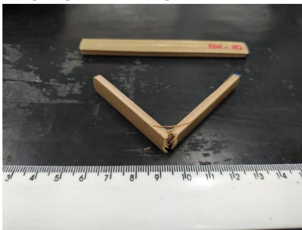
Figura 19 – Corpo de prova fraturado após ensaio de flexão estática
