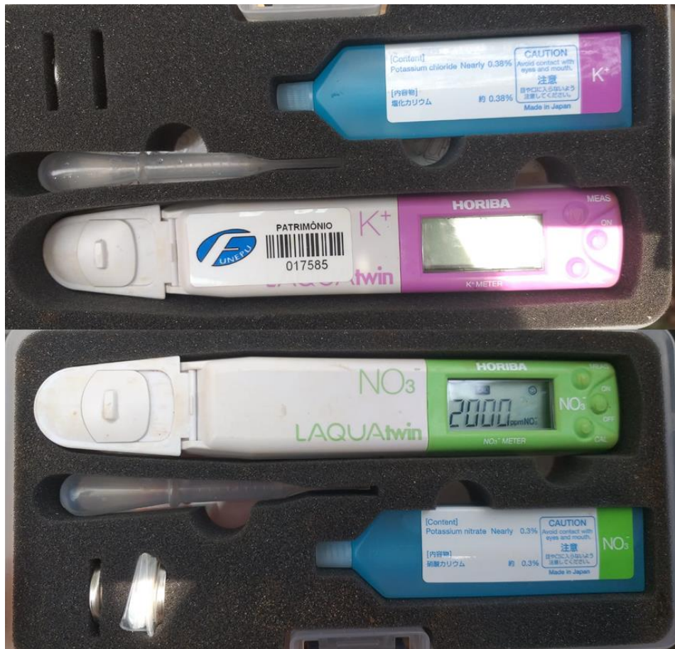
Figura 6- Medição de parâmetros físico-químicos no Ribeirão Ponte Alta utilizando medidor de ION LAQUAtwin K11
