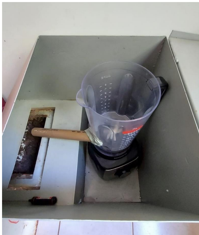
Figura 10: Entrada dos resíduos orgânicos na composteira através do equipamento de trituração.
