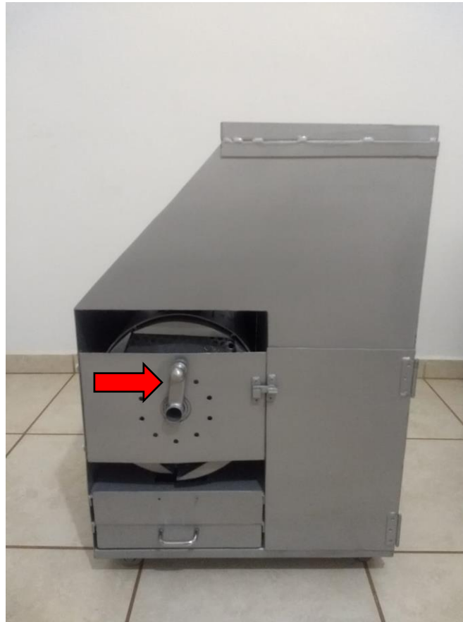
Figura 11: Tambor de rotação e válvula para revolvimento do composto.
