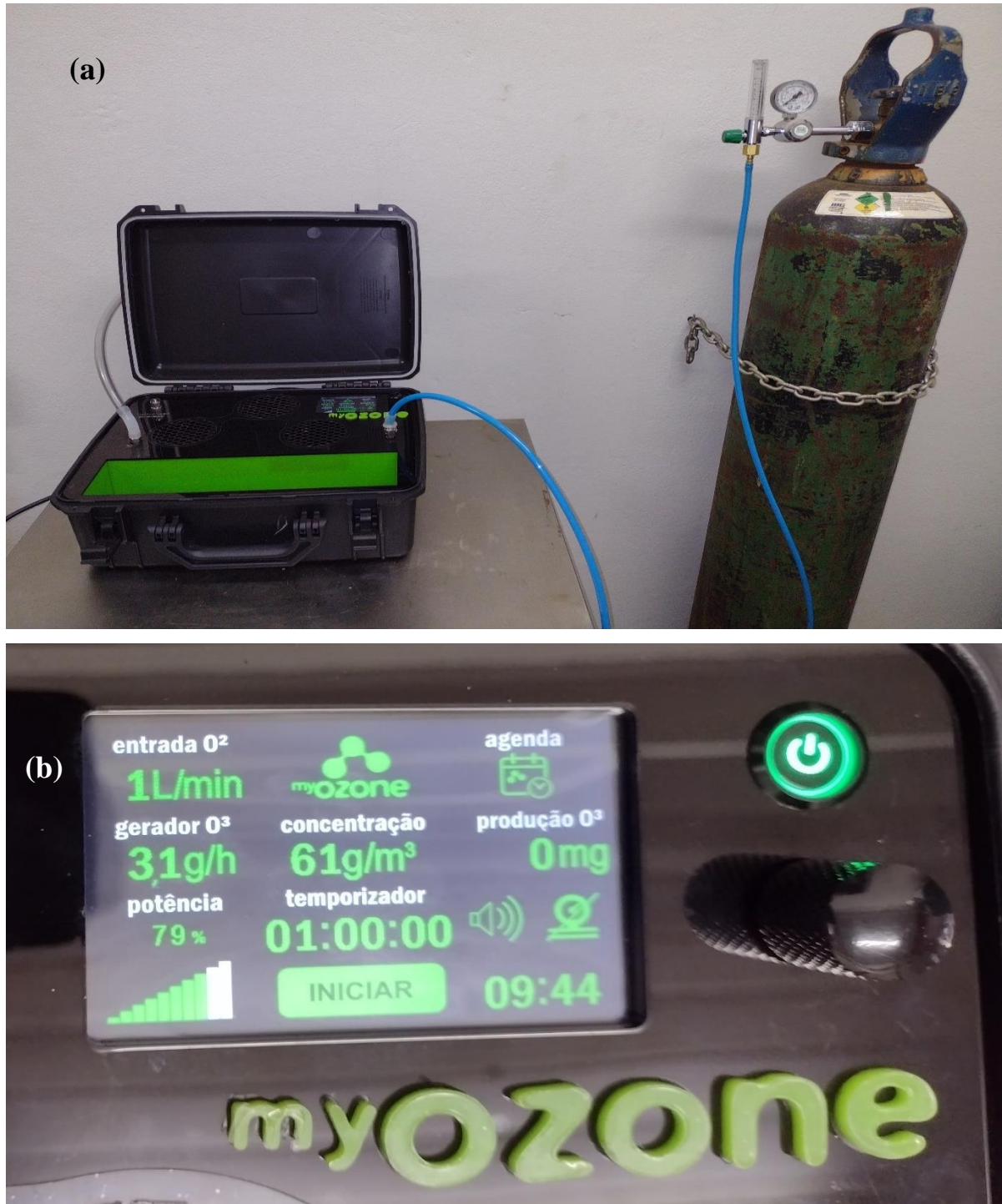
Figura 5 - (A) Fotografia do gerador de ozônio acoplado a um cilindro de gás oxigênio, (B) Fotografia ampliada do monitor digital do gerador de ozônio.
