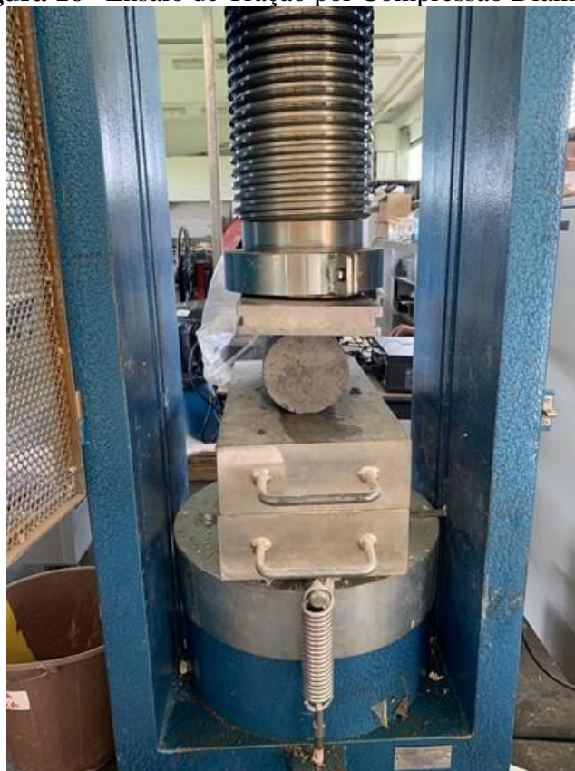
Figura 16 – Ensaio de Tração por Compressão Diametral
