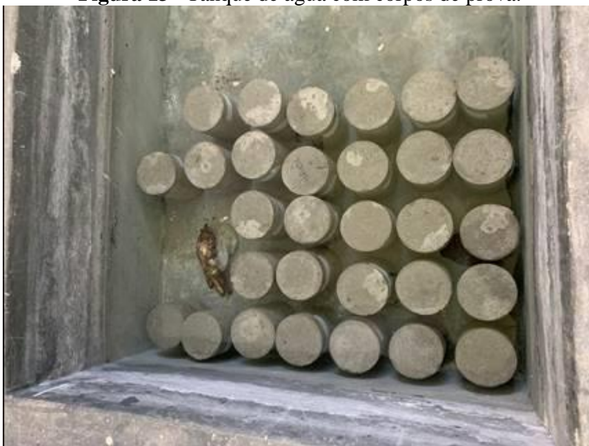
Figura 13 – Tanque de água com corpos de prova.
