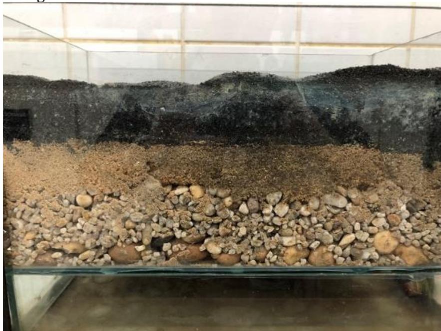
Figura 4 – Material filtrante em um filtro modelo descendente.
