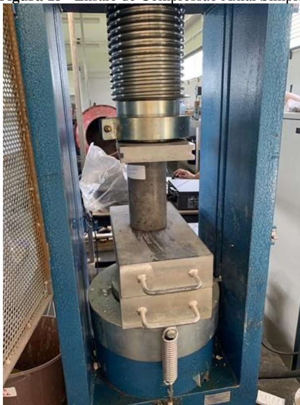
Figura 15 – Ensaio de Compressão Axial Simples
