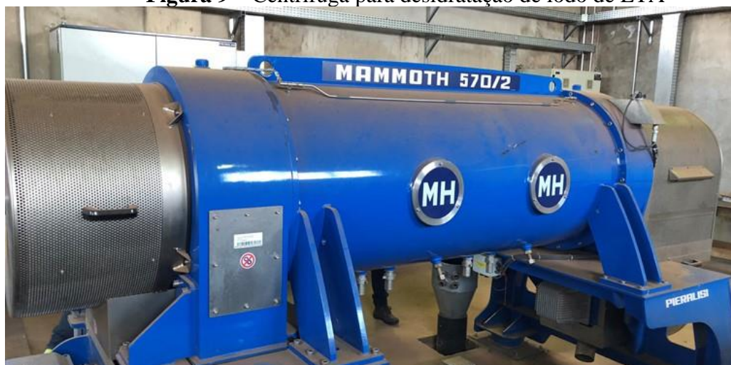
Figura 9 – Centrífuga para desidratação de lodo de ETA
