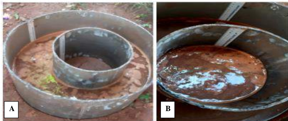
Figura 4 – Realização da análise gravimétrica na EMPTHM: a) Cravação dos anéis no solo; b) Realização das leituras da análise gravimétrica.
