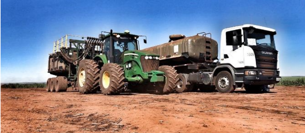
Figura 19 – Trator para aplicação de vinhaça localizada
