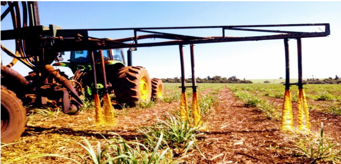
Figura 20 – Trator aplicando vinhaça localizada
