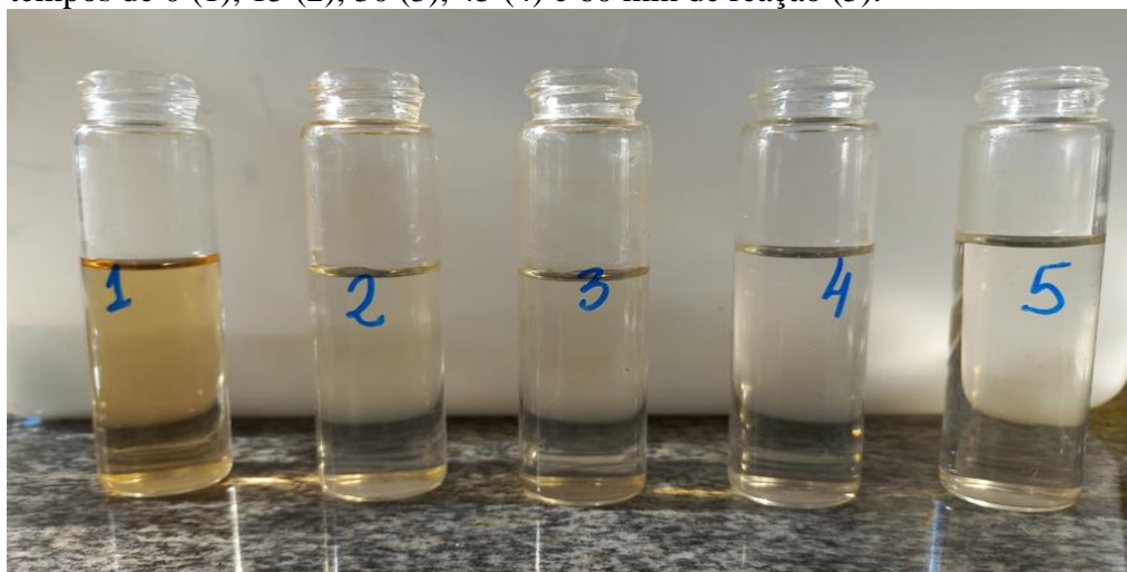
Figura 12: Solução do ácido húmico coletada durante o processo de ozonização não catalítica para os tempos de 0 (1), 15 (2), 30 (3), 45 (4) e 60 min de reação (5).
