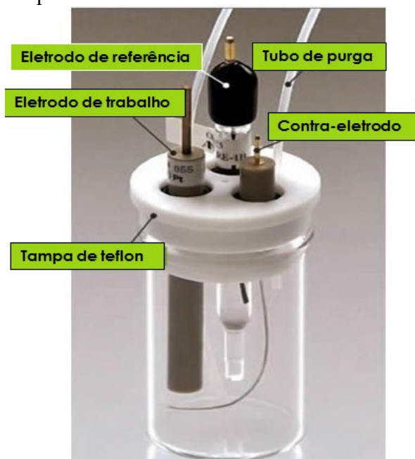
Figura 5 – Célula eletroquímica de três eletrodos.
