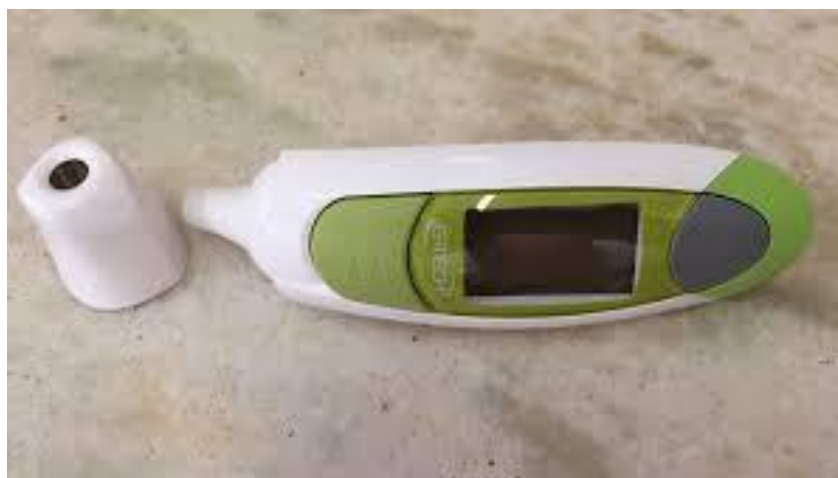
Figura 26 – Modelo do termômetro timpânico infravermelho utilizado para aferição da temperatura auricular do paciente.
