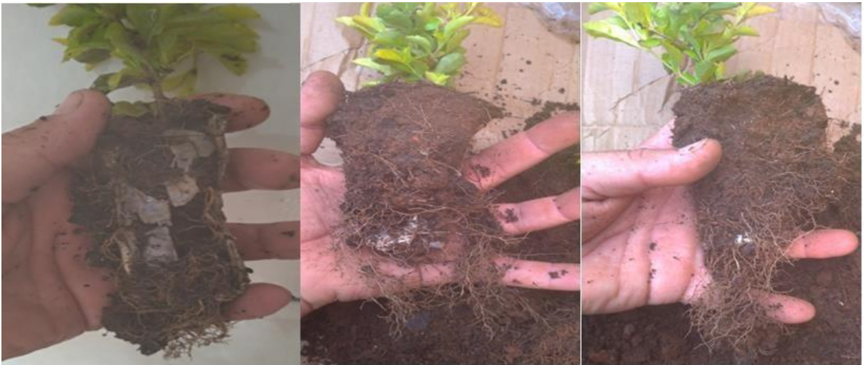
Figura 24- Imagens das raízes de plantas colocadas em vaso com bioplásticos e sua degradabilidade após 30 dias
