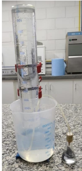
Figura 7- Reator batelada e sistema de medição de gás produzido
