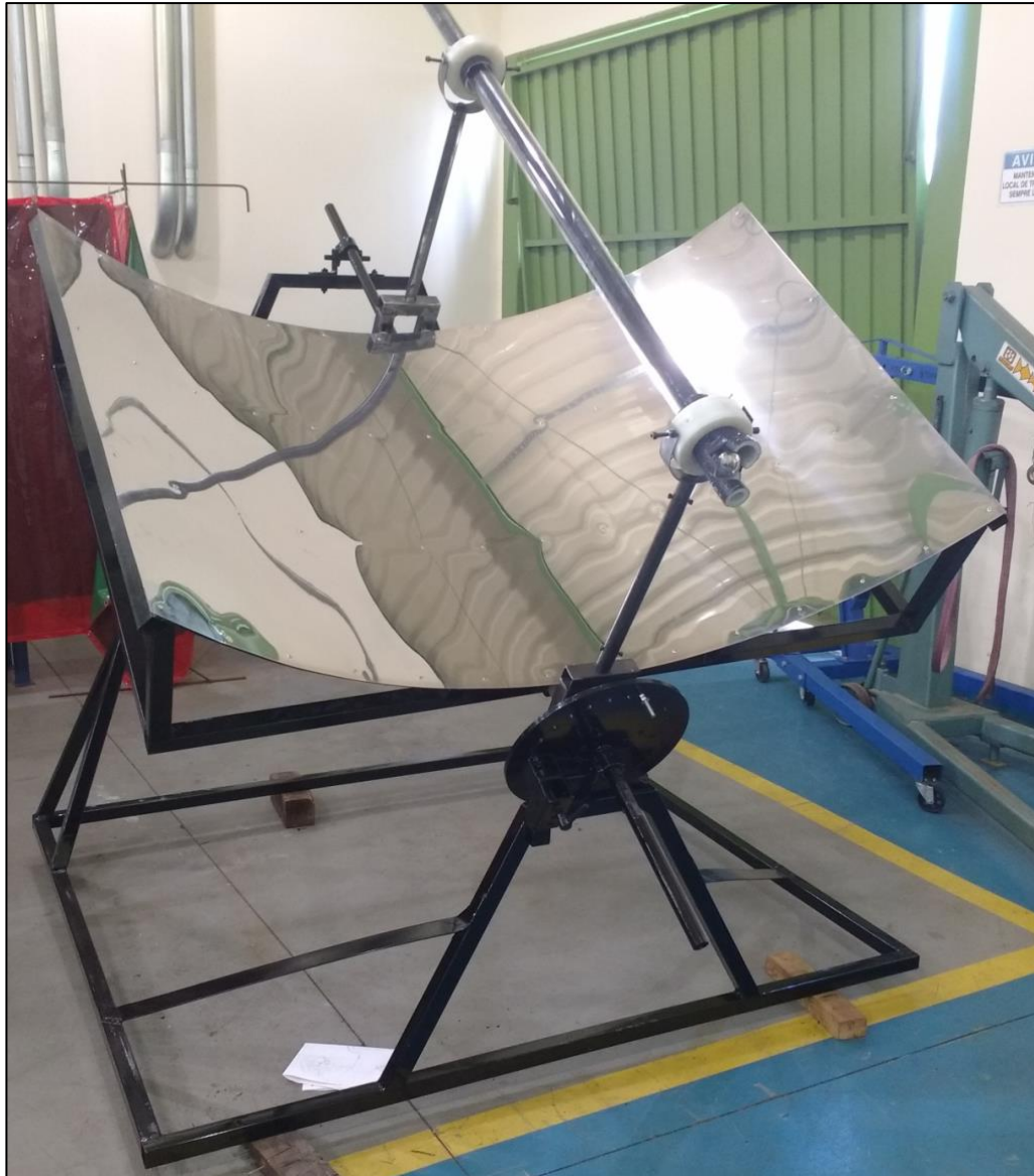
Figura 30 – Coletor solar construído
