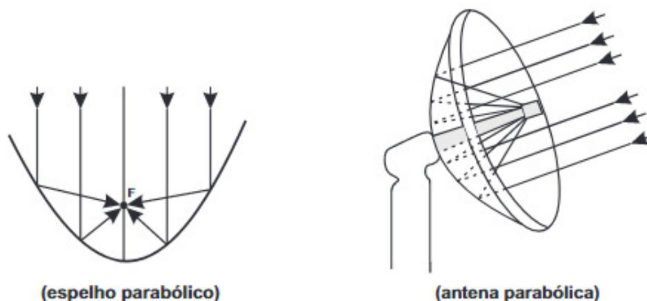
Figura 3.30: Antena parabólica. *Fonte:* VENTURI (2019) (p. 47)
