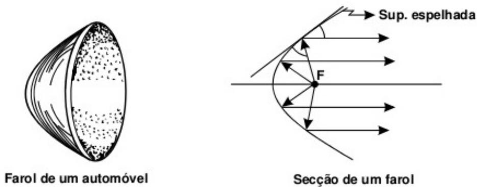
Figura 3.29: Superfície parabólica do farol de um carro. *Fonte:* VENTURI (2019) (p. 46)
