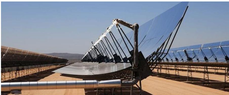
Figura 3.32: Refletores parabólicos. *Fonte:* [https://www.aecweb.com.br/cont/m/rev/energia-heliotermica-e-renovavel-mas-incipiente-no-brasil\\_12417100](https://www.aecweb.com.br/cont/m/rev/energia-heliotermica-e-renovavel-mas-incipiente-no-brasil_12417100) (acesso : 12/01/2020)
