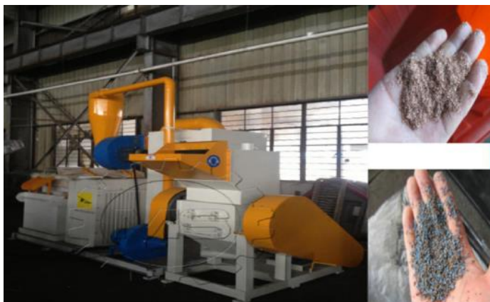
Figura 11 - Conjunto de máquina de reciclagem de placas de circuito impresso a seco e produtos obtidos após a separação.
