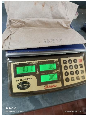
Figura 10 – Pesagem da parcela de amostra antes da secagem, em laboratório.
