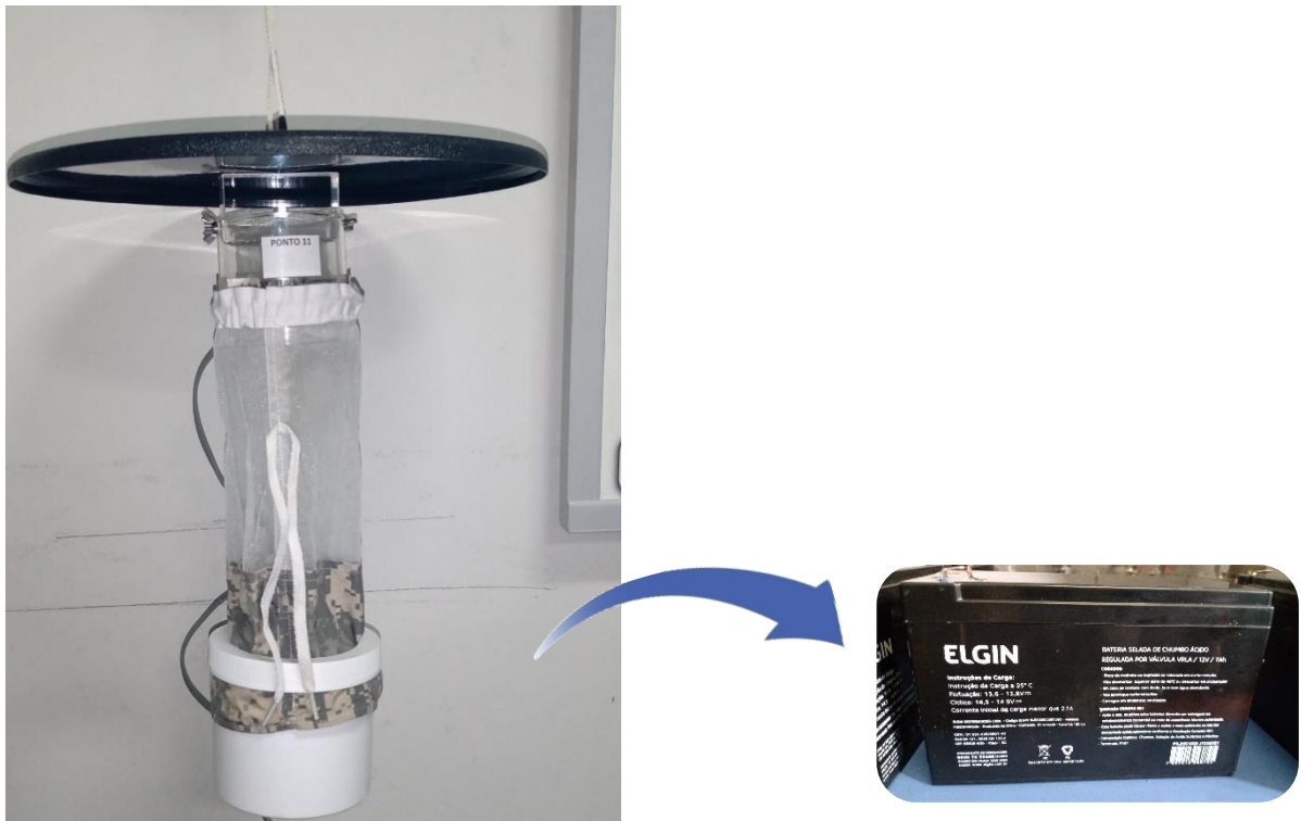
Figura 7 – Armadilha luminosa tipo CDC (marca: John W. Hock Company®) utilizada na captura de flebotomíneos e operada por bateria com tensão 12V/7Ah
