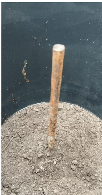
Figura 17 – Método 2: Haste sem método para evitar a oxidação
