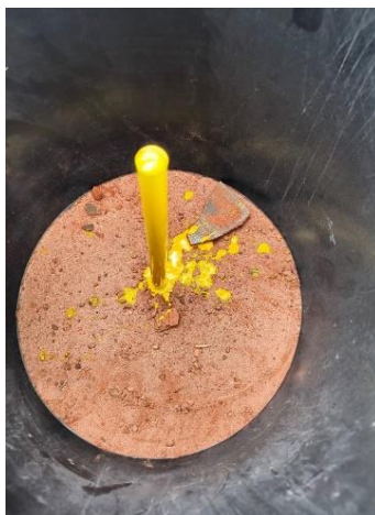
Figura 19 – Haste pintada com tinta isolante líquida e utilizando massa plástica
