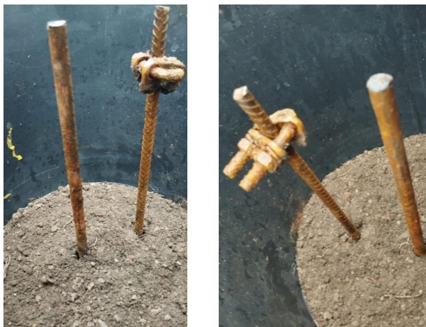
Figuras 18 (a) e (b) – Método 2: Haste utilizando metal de sacrifício
