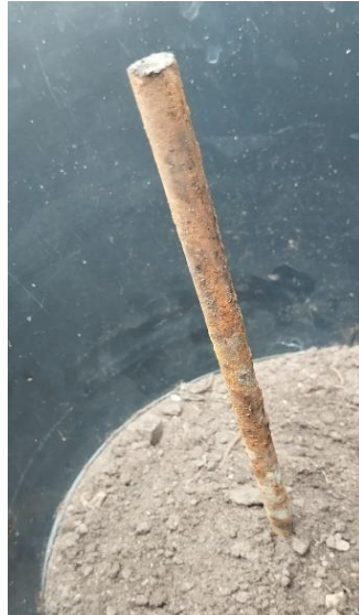
Figura 22 – Método 4: Haste sem método para evitar a oxidação
