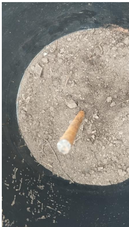
Figura 14 – Método 1: Haste sem método para evitar a oxidação
