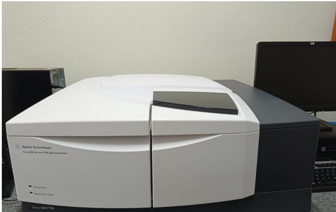
Figura 11 – Espectrômetro utilizado para as medidas de FTIR
