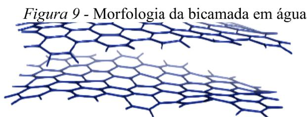
A morfologia obtida do grafeno bicamada AB, 9 x 4 y em água é homogênea com curvatura de ambas as folhas. Fonte: Da autora (2021)
