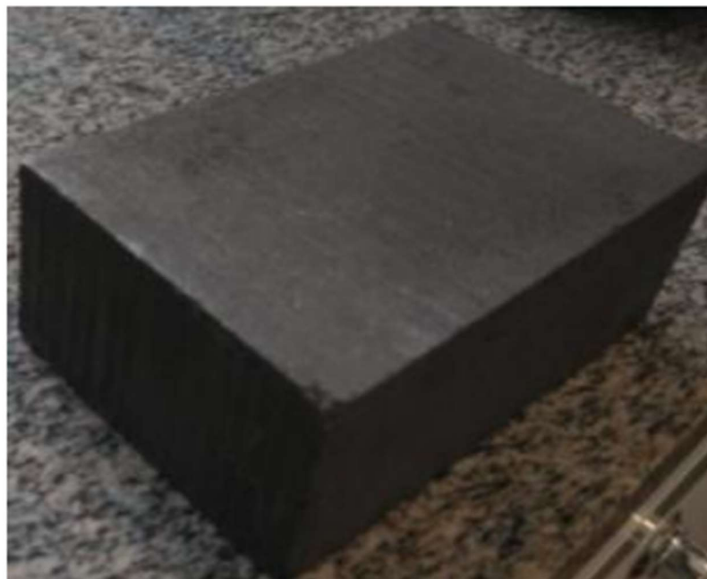
Figura 24 - Bloco de grafite utilizado para minimizar a presença de oxigênio na atmosfera do forno.
