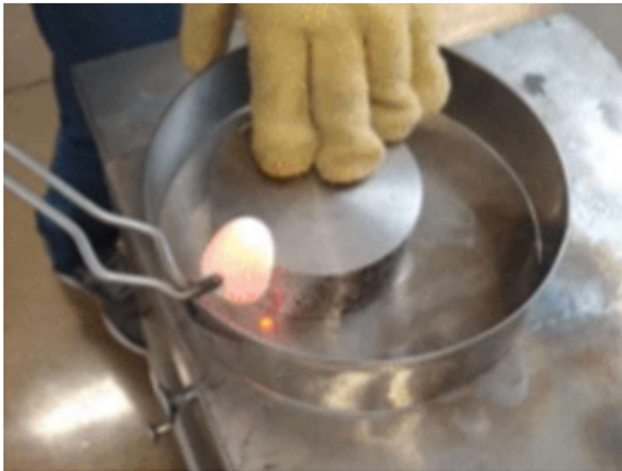
Figura 26 - Melt vertido e prensado em temp. ambiente.
