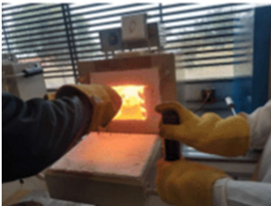
Figura 25 - Obtenção das amostras por fusão a 1200°C.
