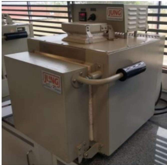
Figura 23 - Forno fabricante Jung-mod: LF 00613 aquecido previamente a temperatura de 1200°C.
