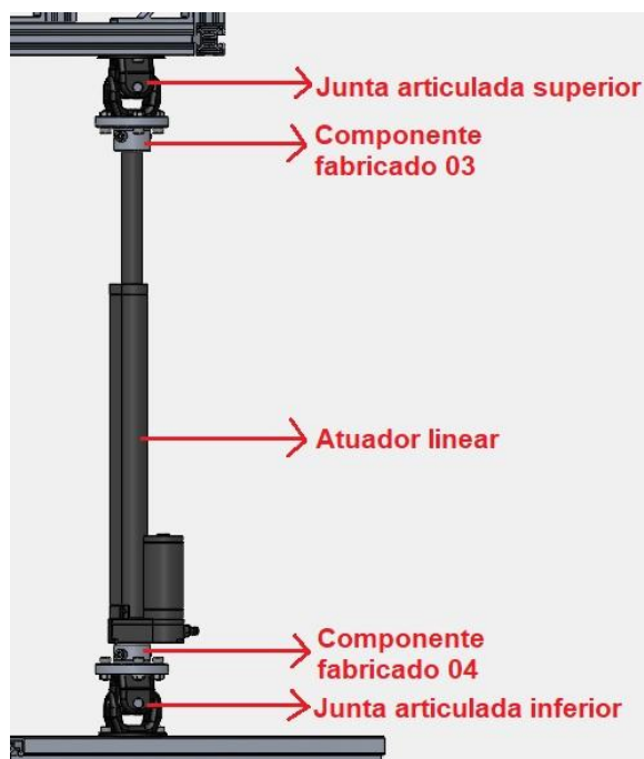
Figura 19 - Montagem do atuador, juntas e componentes fabricados 03 e 04 nos perfis da estrutura.
