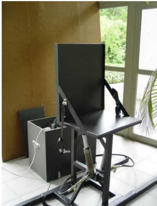
Figura 4 - Cadeira inclinável utilizada por Saeys e colaboradores em 2010.
