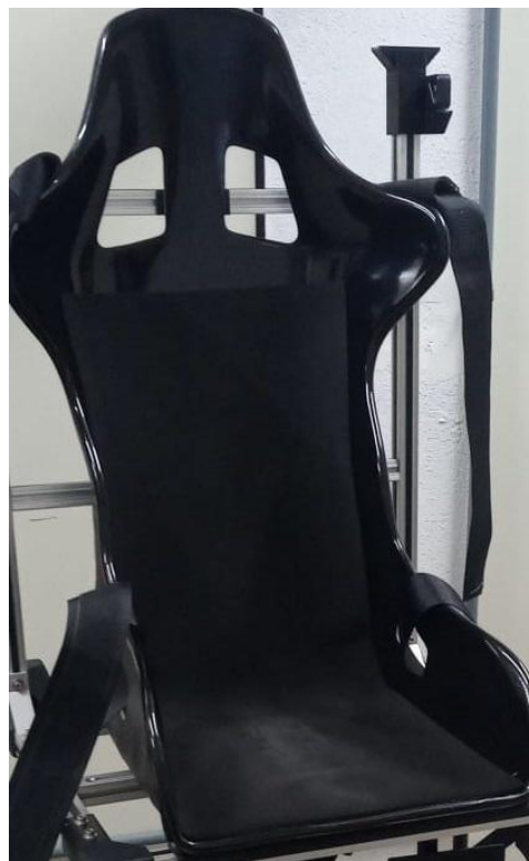
Figura 57 - Instalação de mantas de EVA no assento e encosto do banco de fibra.
