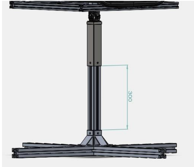
Figura 36 - Comprimento da coluna sujeito a flambagem.
