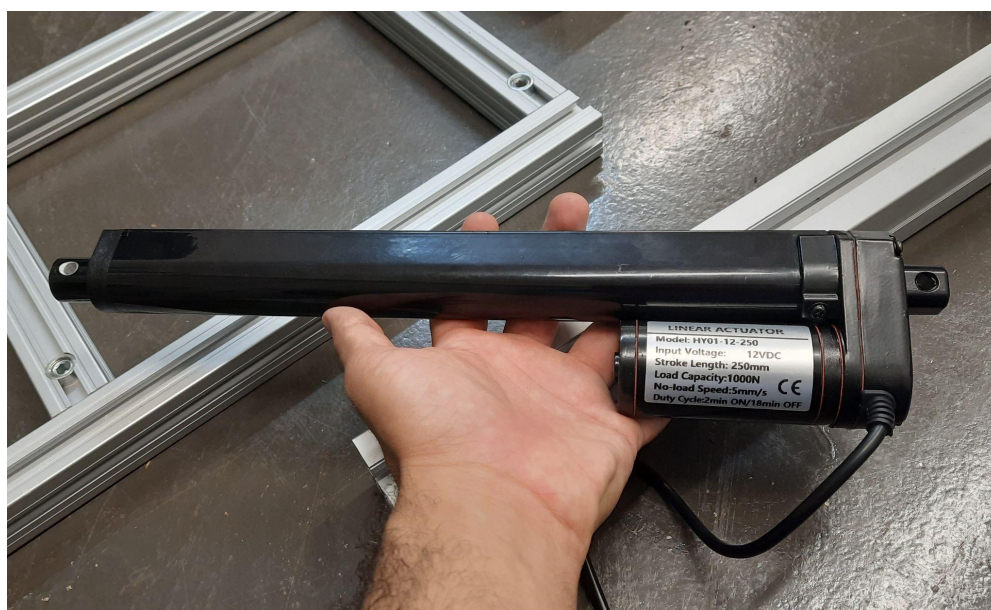
Figura 43 - Atuador elétrico linear escolhido.
