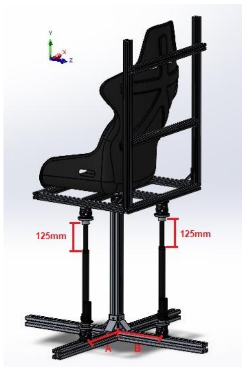
Figura 20 - Montagem e distâncias dos atuadores lineares.
