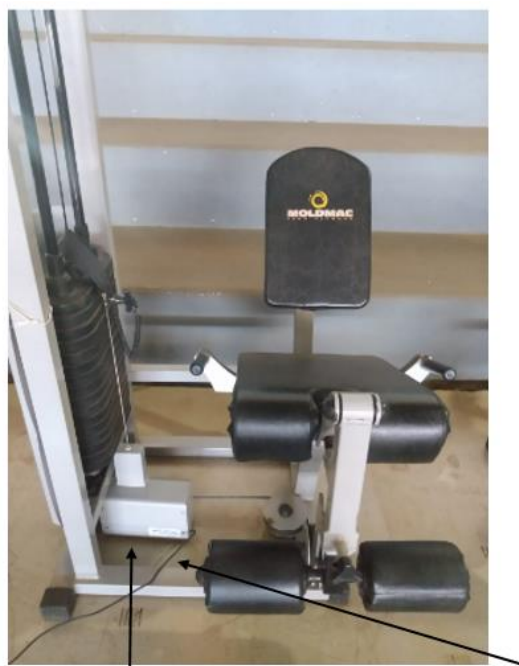
Dinamômetro isoinercial acoplado ao cabo da cadeira extensora
